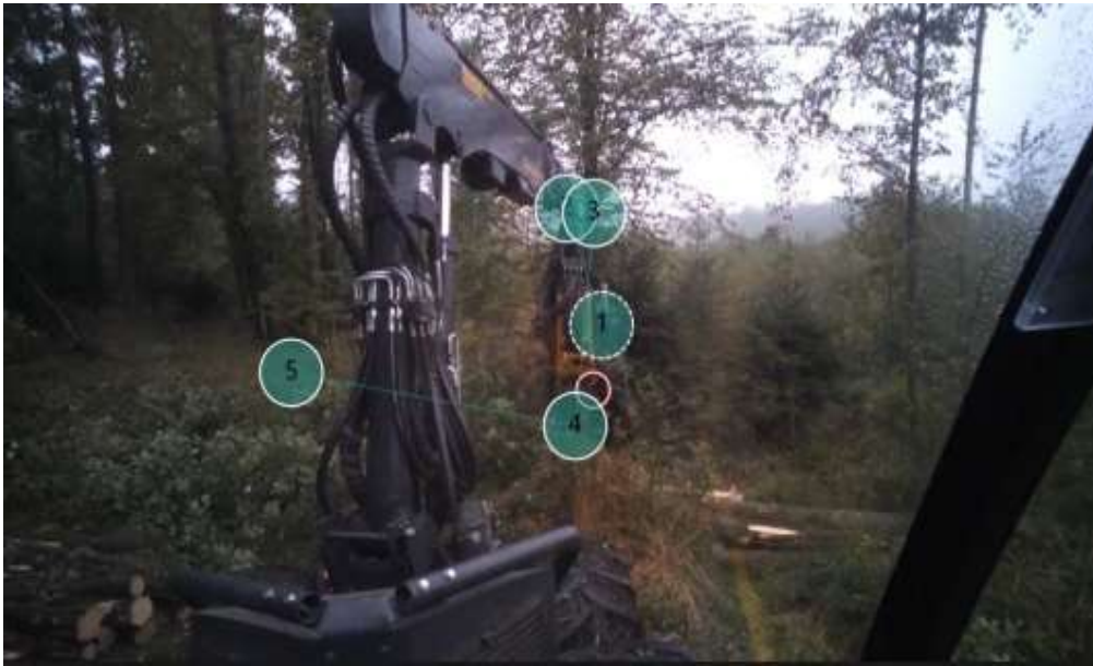
Rys. 2. Ścieżka skanowania wzrokiem przy ścinie drzewa harvesterem.
